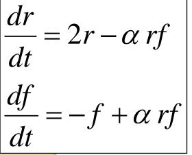
• r=w(1) • f=w(2) function z=rkfox(t,w) alpha=0.01; **r=zeros(2,1)**; z(l)=2\*w(l)-alpha\*w(l)\*w(2); z(2)= -w(2)+alpha\*w(1)\*w(2);
